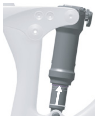
Figura 87: Spostamento dell'O-ring sull'ammortizzatore del carro posteriore
