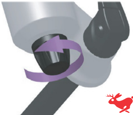
Figura 137: Rotazione dell'ammortizzatore a stadi di trazione in direzione lepre
