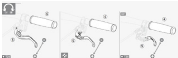
Figura 77: Regolazione dell'ampiezza di presa della leva del freno Magura con freno a disco
