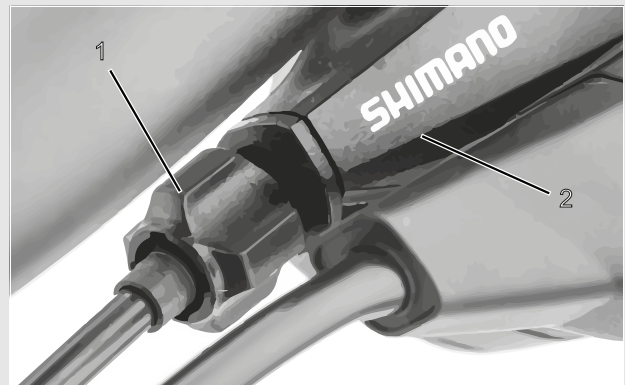
Figura 131: Boccola di regolazione (1) del cambio azionato da cavo singolo con scatola della leva del cambio (2), esempio
