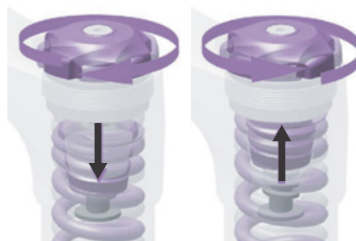
Figura 82: Avvitamento o svitamento dell'anello di regolazione del precarico.
